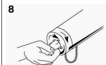
Проверните наконечник насадки в крышке шприца по часовой стрелке до его полной фиксации в пазах. Вытяните полностью наконечник насадки.
