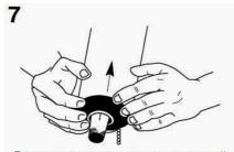
Возьмите пакет с приготовленной массой в обе руки. Сформировав цилиндрическую форму, установите пакет во внутреннюю полость шприца Scotchcast® E-4. При необходимости сложите пакет в форме цилиндра для удобной установки в шприц.
